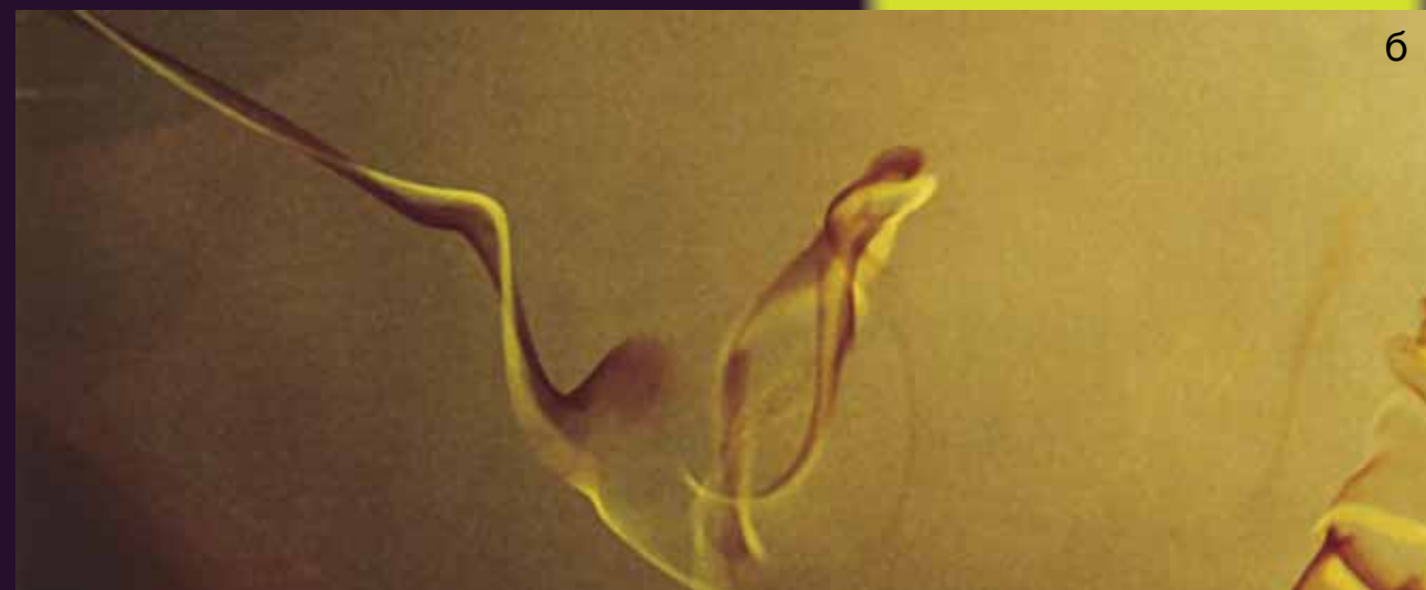
Распад вихрей на подветренной стороне модели транспортной космической системы (A. Stromberg, W. Limberg, 1993): а — вид сверху; б — вид сбоку
